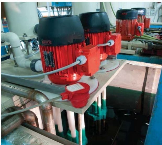
F 716 Циркуляция химикатов в ванне с электролитом
